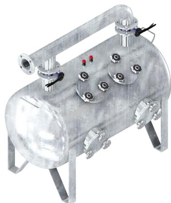
Il filtro a doppia camera è realizzato in acciaio zincato a caldo, completo di n. 4 aperture per il carico e lo scarico della quarzite. Si consiglia l'utilizzo di una granulometria non superiore ad 1 - 2 mm. Fornito come da figura con collettore, saracinesche di entrata, uscita e scarico, sfiati, manometri inox alla glicerina, bulloni e guarnizioni
