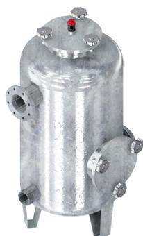
Il filtro a graniglia è realizzato completamente in acciaio zincato a caldo completo di rete trasversale, consigliamo l'ausilio di spaccato di quarzo da 5 - 6 mm. Viene fornito con : n. 1 valvola di scarico d. 1" e n. 2 manometri inox alla glicerina
