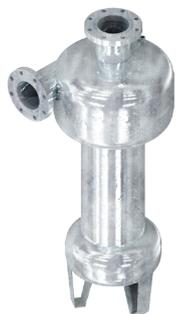
Il filtro idrociclone tradizionale, interamente zincato a caldo, sfrutta la legge centrifuga per separare solidi in sospensione dall'acqua immessa ad alta velocità. Le impurità si depositeranno all'interno del serbatoio posto alla base del filtro stesso. Fornito completo di valvola a sfera per lo svuotamento del serbatoio
