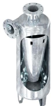
Il filtro idrociclone CS/92, interamente zincato a caldo, è consigliato in presenza di acque molto sabbiose. La struttura esterna crea una doppia camera con il corpo conico, tale da permettere l'espulsione del 99% dei solidi sospesi. Questo filtro garantisce longevità d'impiego al consumatore, in quanto l'erosione del cono causata dal vorticare ad alta velocità della miscela acqua sabbia, non provoca alcun danno strutturale. Fornito con valvola di scarico
